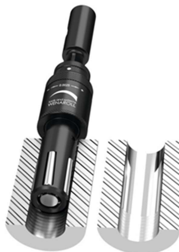
Figura 4, izquierda. Durante el bruñido; dcha. después del bruñido
